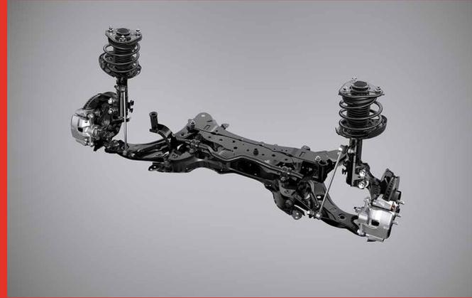
Suspensión delantera tipo Mc pherson.
