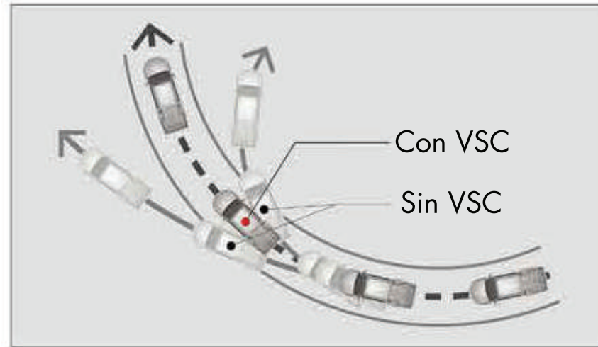
VSC: Ayuda a prevenir que el vehículo resbale, reduciendo la fuerza del motor y frenando los neumáticos que lo requieran.*2
