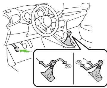
2. Pise el pedal del embrague y mueva la palanca de cambios a la posición de la 1ª marcha o la marcha atrás (R).\*2
