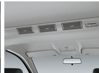
Sistemas de ventilación posterior integrado en el techo, haciendo llegar el confort del aire acondicionado a todos los ocupantes.
