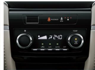
Controles de aire acondicionado automático e indicadores de recordatorio de uso de cinturones de seguridad.
